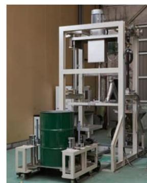
図1. インドラム方式混練装置
