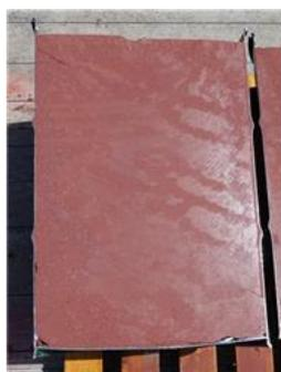
図2. ジオポリマー固化体の断面写真
