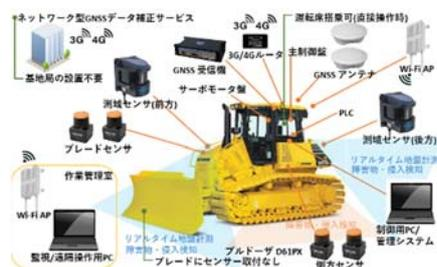
図-1 ブルドーザ自動運転システム
