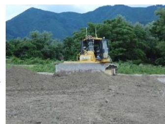
図-2 自動運転試験状況
