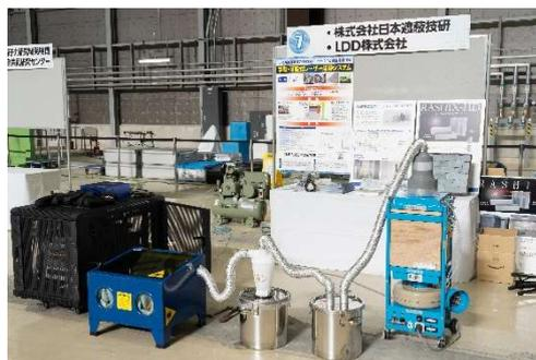
写真1、車載レーザー除染システムの展示。
