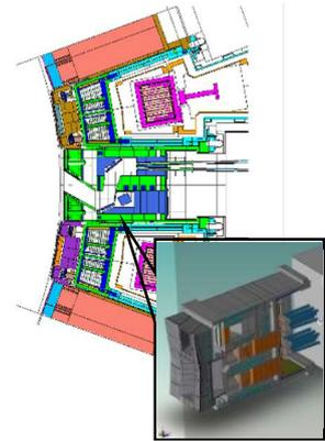
図1. トカマク 40<sup>+</sup> ITER ランチャー核解析モデル<sup>[1]</sup>
