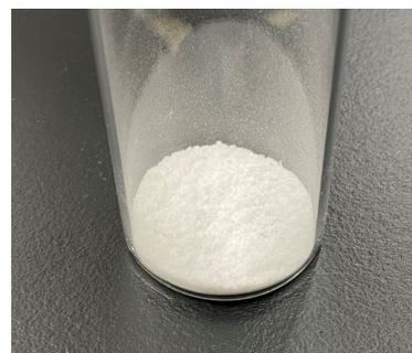
図1. 回収した炭酸リチウム
