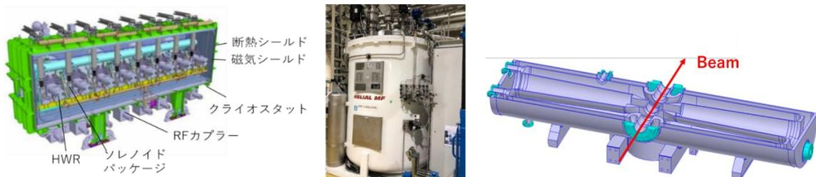
図 1. LIPAc の SRF クライオモジュール(左)と冷凍機システム(右). 図 2. LIPAc の HWR 空洞.
