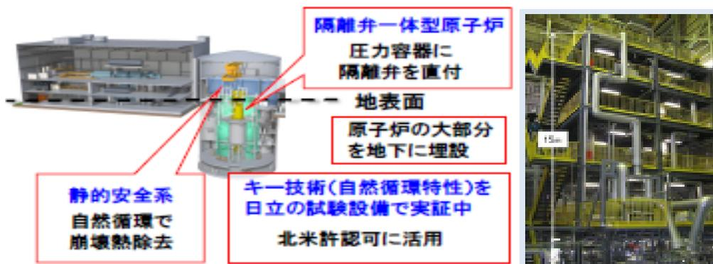
日立多目的蒸気源試験装置
