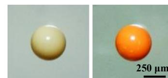
図 2. 初期状態(左)及び UO<sub>2</sub><sup>2+</sup>吸着後(右)における吸着材の外観
