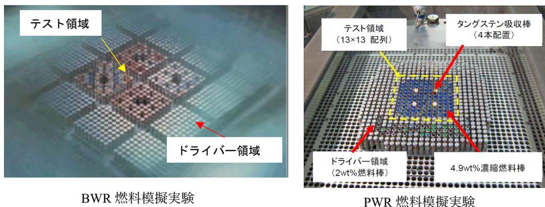
図2 燃料集合体模擬実験の例 (参考文献2より引用)
