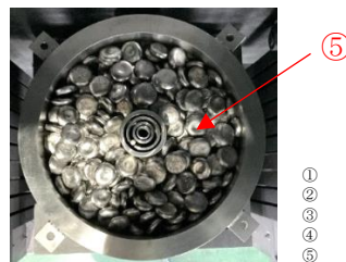
図 2 模擬デブリ充填状態
