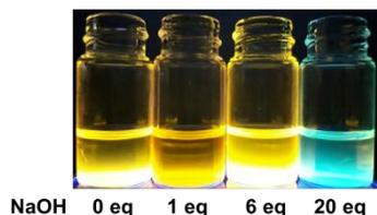
**Figure 1.** **1** の NaOH 存在下での発光の写真 [0.10 mM in DMSO/H<sub>2</sub>O = 20:1 (v/v),  $\lambda_{\text{ex}}$  = 365 nm].
