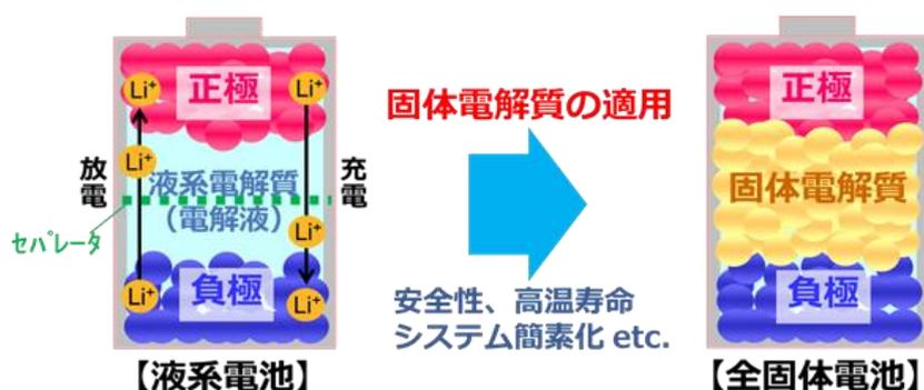
図 1. リチウムイオン電池の全固体化<sup>1)</sup>
