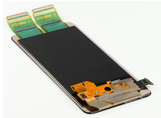
Fig. 4 FOD Module with OLED Display
