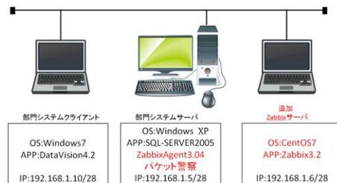
図 2: Zabbix サーバを追加し、部門システムクライアントの MAC アドレスを登録する。また、部門システムサーバにパケット警察と、Zabbix エージェントをインストールする。
