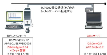
図 3: Zabbix エージェントが、パケット警察の通信ログを転送する。
