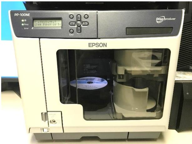
図 8 出力ツールとディスクデュプリケータの組合せによる書き込みからラベル印刷の自動一元化
