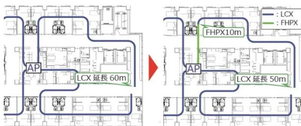
図 11 FHPX を用いた LCX 配線計画例
