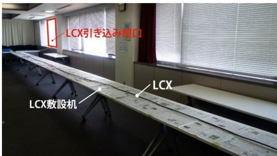
図5 測定室内 LCX 敷設状況
