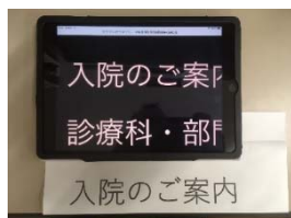
図 4 9.7"ディスプレイ iPad による 100pt 文字の表示 iPad の下にあるのは A4 用紙に印刷した 100pt の文字(游ゴシック Light(Bold))である。
