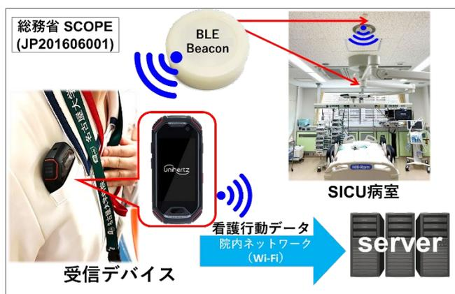
図 2 受信デバイスと位置測位システム構成
