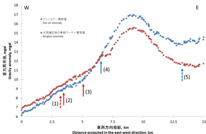
図 2 重力異常稠密測定の結果 東西断面 赤色矢印は吉岡・他(2013), 青色矢印は岡田・他(1996)および岡田・他(2009)による活断層位置を示す. 実線は確実度の高い活断層, 破線は推定活断層.
