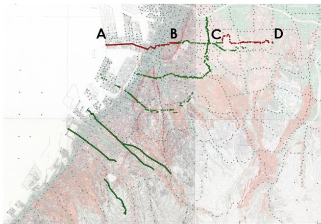
図 1 重力測定点の位置 A-B, C-D : 今回の測定点(赤印), その他は筆者によって公表された測定点(緑印). 小さな点はその他の既存の測定点. 吉岡・他(2013)の断層線を記入してある.(中田・他(1996), 中田・他(2009), 岡田・他(1996), 岡田・他(2009)に加筆).
