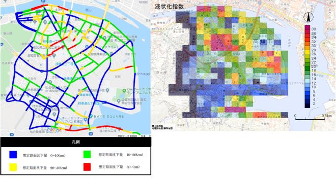
避難路用の道路での地盤の液状化による想定路面沈下量
