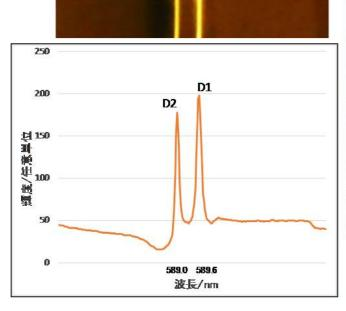
上:製作した簡易分光器の型紙とその精度(ナト リウムのD線が2本に分光されている)
