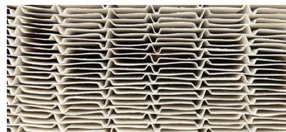
図2. プレート型酸化触媒。
