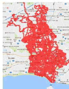
図2: 慶應大学が開発した清掃車を用いたセンサーネットワークのカバレッジ
