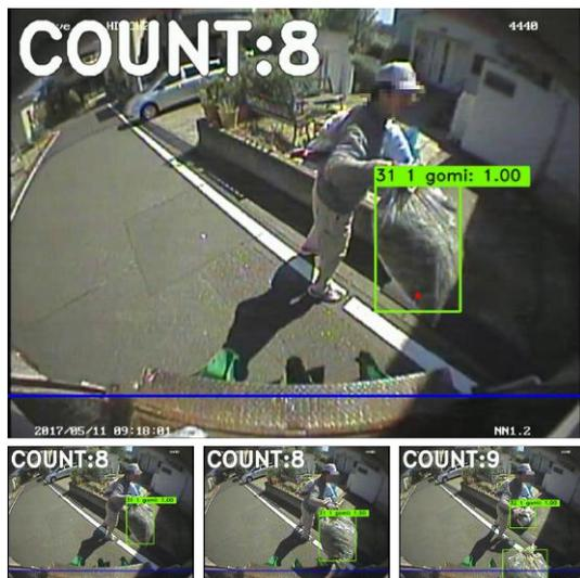
図 6: (上): 実際に清掃車後部に取り付けられたドライブレコーダーで撮影された動画のフレーム画像. (下): ゴミ袋がフレーム間において上方から下方へ移動しトラッキング, カウントされている.
