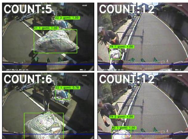
図 8: (左): ゴミ袋が大きく写っているためトラッキングが成功して正しくカウントできている。(右): 2つのゴミ袋が画面横方向に近いためトラッキングが失敗しカウントできていない。
