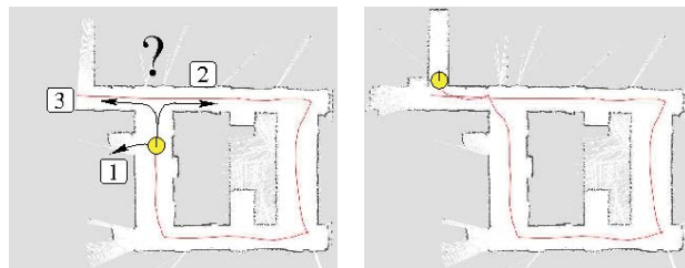
図 2: 能動的地図生成における動作候補及び最適な動作 [Stachniss 05]
