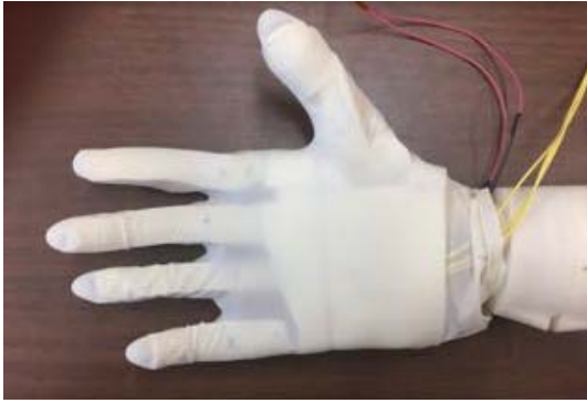
図 2: 人肌を再現したカバー装着した状態のロボットハンド
