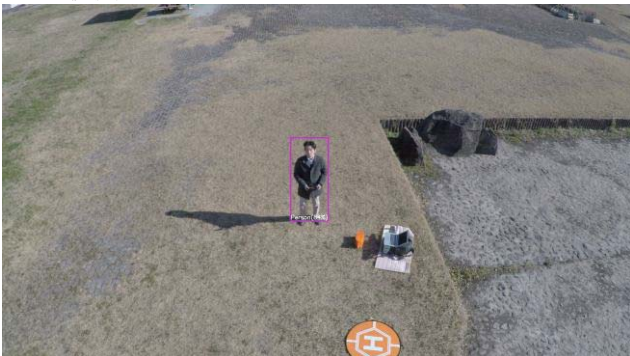
図 7 物体検出により人を認識したときの映像（高度 6 m, 図 5 から 8 秒後）
