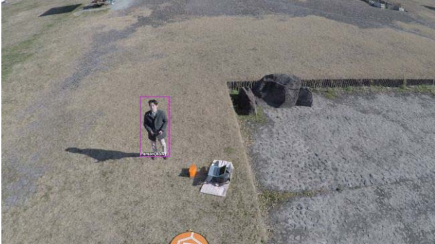
図 6 物体検出により人を認識したときの映像（高度 6 m, 図 5 から 6 秒後）
