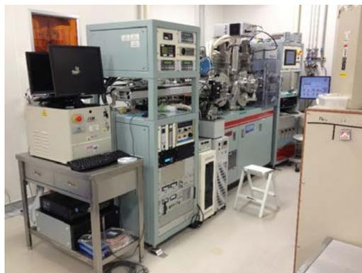
図 1. Nb/Al 多層膜成膜用スパッタ装置
