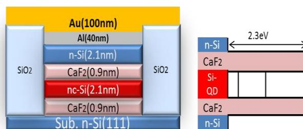
Fig. 1 素子の断面層構造と伝導帯バンドプロファイル
