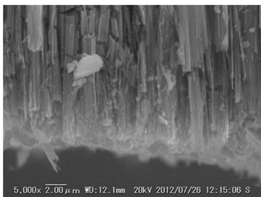
図 1.  $\text{Eu}_2\text{SiS}_4$  を形成したシリコンナノワイヤー試料の断面図
