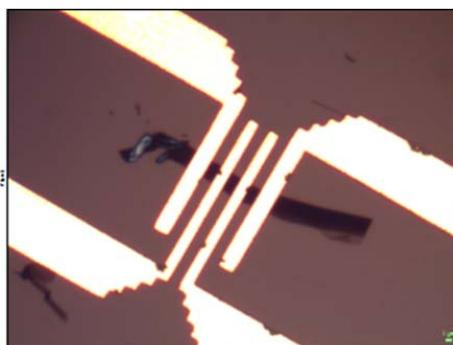
Fig.1 多層グラフェンの光学顕微鏡写真(電極作製後)
