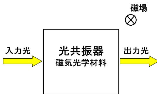
図 1 磁気光学材料を用いた光共振器の概要
