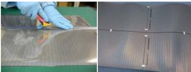
図 1 セルの切断、貼り合わせによるカスタマイズ
