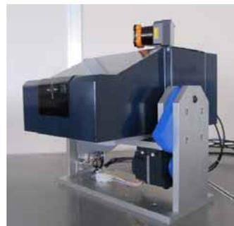
図 より定量的計測可能な放射線可視化装置  $\gamma$ -eye II<sup>[4]</sup>
