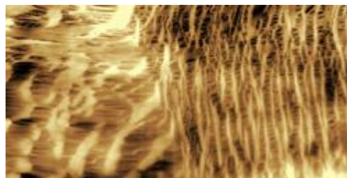
Fig.2 電解液を含浸したセパレータの原子間力顕微鏡像
