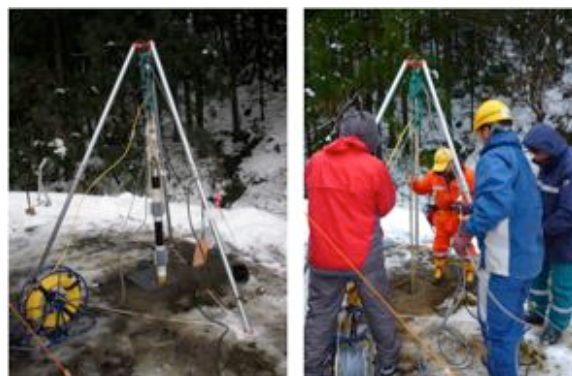
図 2. SQUID による鋼管を通した検層試験
