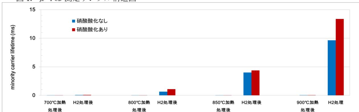
図 2. 硝酸酸化+加熱処理後 n 型単結晶シリコンウェーハの少数キャリアライフタイム
