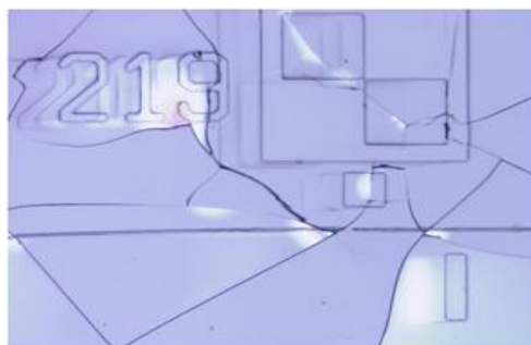
図1 PMGI に発生したクラック
