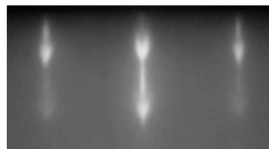
図 2. InSb( $30^\circ$ )上に成長中の GaSb の RHEED パターン
