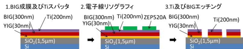
図 5 BIG を用いたフォトニック結晶共振器製作法
