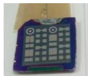
図 1. ZnO-TFT の外観写真
