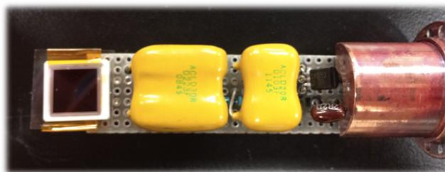
図 2 APD 極低温シンチレーション光検出装置
