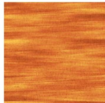
図2. 1500°C、V/III比100で成長したa面AlNのAFM像 (5×5-μm)。
