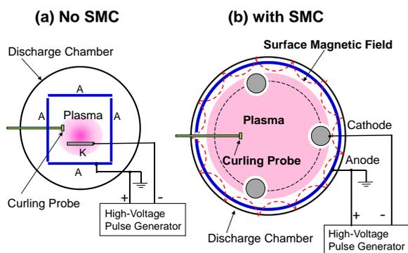
Fig. 1. Discharge apparatuses.
