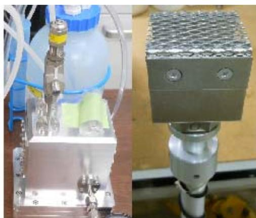
図 2. 開発した雰囲気セル (左) および試料ホルダー (右)
