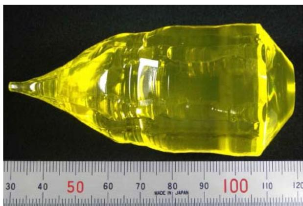
図 1：直径 2 インチの SCP YAG
