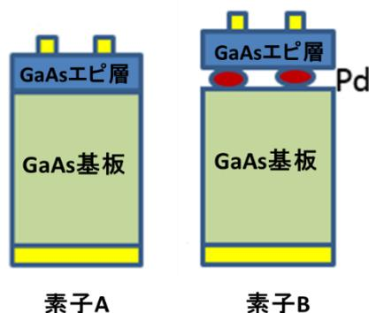
図 1 : 抵抗測定用素子簡易構造図
