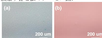
図3. (a) 4.5-nm Al<sub>2</sub>O<sub>3</sub>, (b) 0.5-nm Al<sub>2</sub>O<sub>3</sub>/2.0-nm HfO<sub>2</sub> で貼り合せた基板の700°C加熱後の顕微鏡写真.
