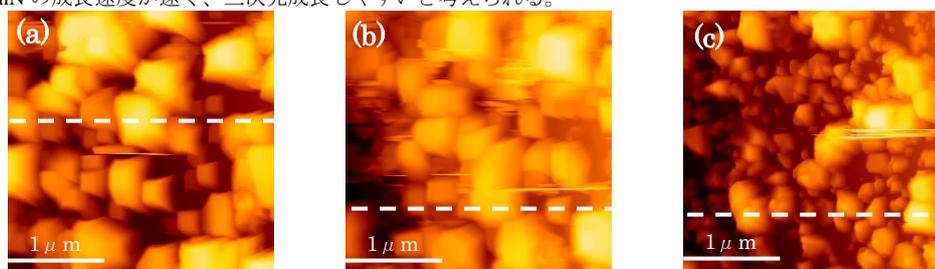
図.1 InN 成長層の表面モフォロジの基板依存性(a)グラフェン基板(Si 面), (b)グラフェン基板(C 面), (c)SiO<sub>2</sub>基板
