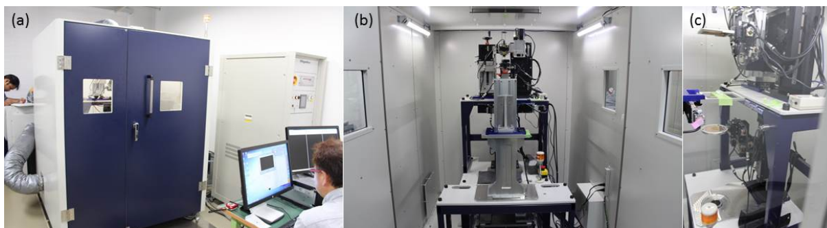
図1 開発した装置の写真。遮蔽室(a)内に縦型X線 Talbot-Lau 干渉計(b, c)が設置されてい
