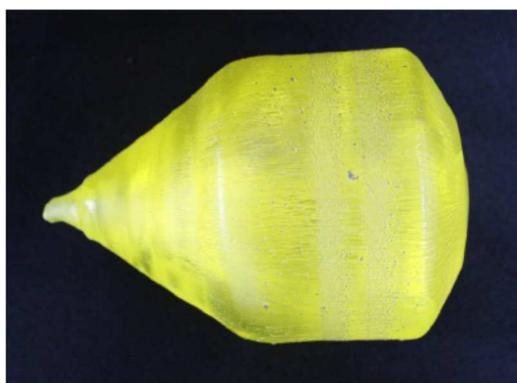
図1 3インチサイズ Ce:GAGG 単結晶の写真
